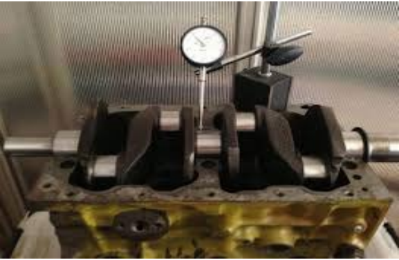
クランクシャフトの曲りを測定する。
